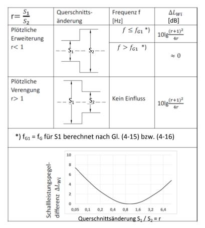
Tabelle 4-7: Dämpfung aufgrund einfacher Querschnittssprünge (nach VDI 2081) [4-2]
