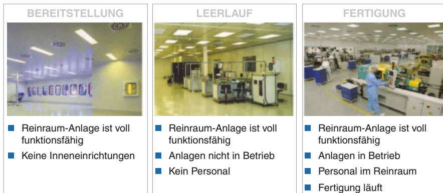
Abb. 1.6 Betriebszustände zur Festlegung und Überprüfung der Luftqualität
