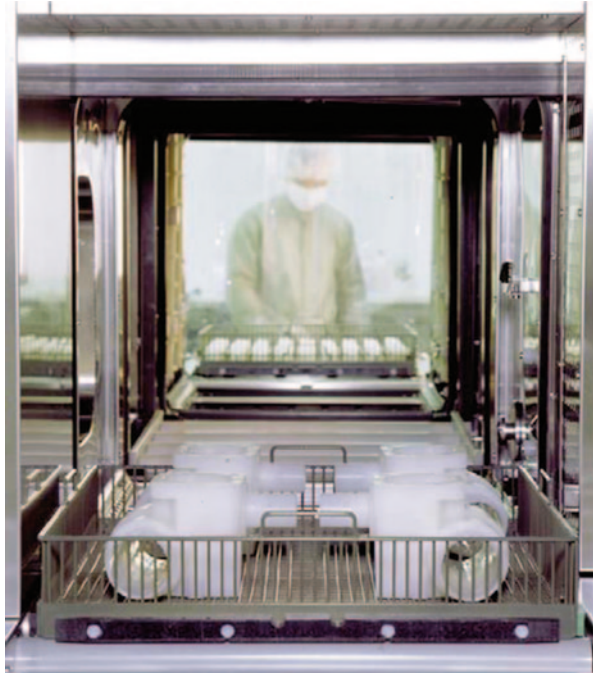
Abb. 1.12 Reinigungsanlage mit Schleusenfunktion für High-Purity Armaturen. (Quelle: GEMÜ. Ausnahmsweise sind beide Schleusentüren gleichzeitig geöffnet)
