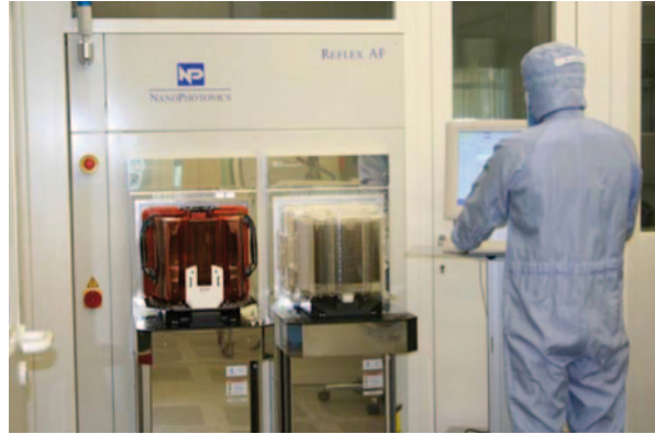
Abb. 1.19 Equipment mit Front Opening Unified Pod (FOUP) Schnittstellen. (Quelle: Fraunhofer IPA)
