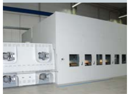
Schallschutzkabine für eine Glasbearbeitungsanlage
