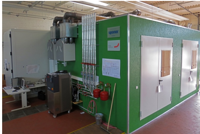
Abb. 3: Klimakammer der Hochschule Offenburg für die Analyse von AMLR-Anwendungen im Büro.
