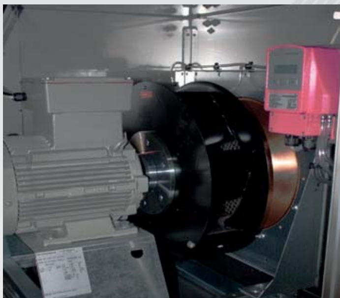
Bild 19: Freilaufendes Rad in ATEX-Ausführung
