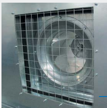
Ansaugschutzgitter für Freiläufer.
