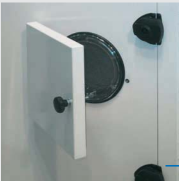
Schauglasabdeckung zur Vermeidung von Keimwachstum.
