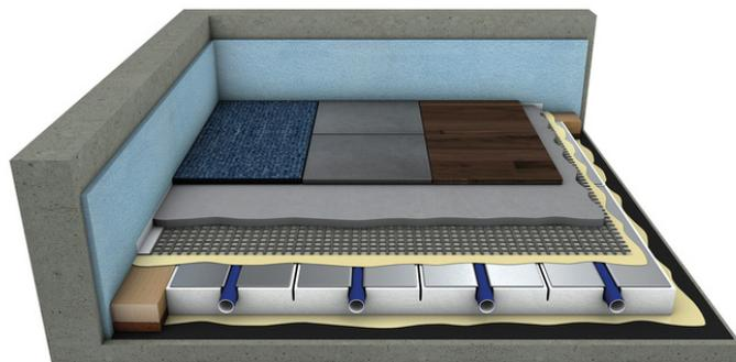
Bilder: Dünnschichtsystem mit Ausgleichsmasse
