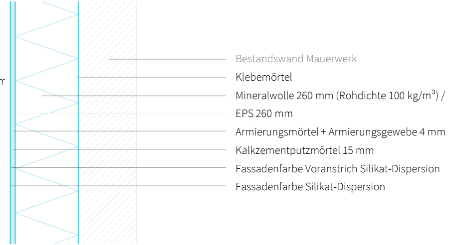
Fassade WDVS Mineralwolle / WDVS EPS
